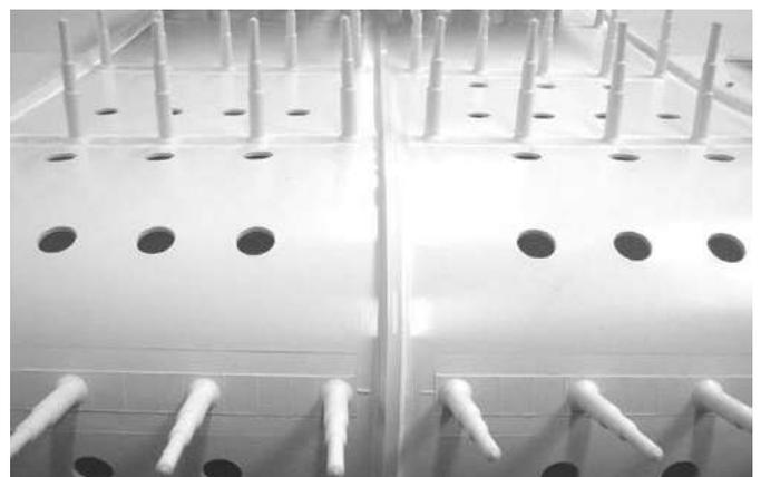
Bande à doigts, profils et perforations
