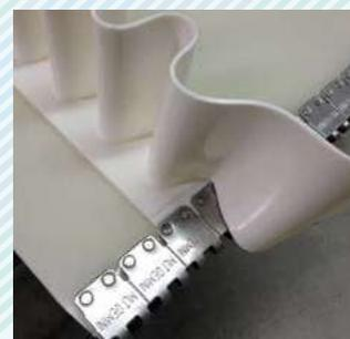
Agrafe à rivets avec finition Compart™
