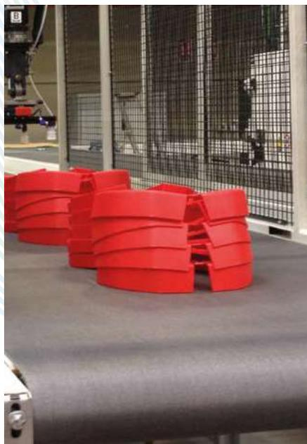
Bande silencieuse avec face porteuse en tissu pour l'accumulation
